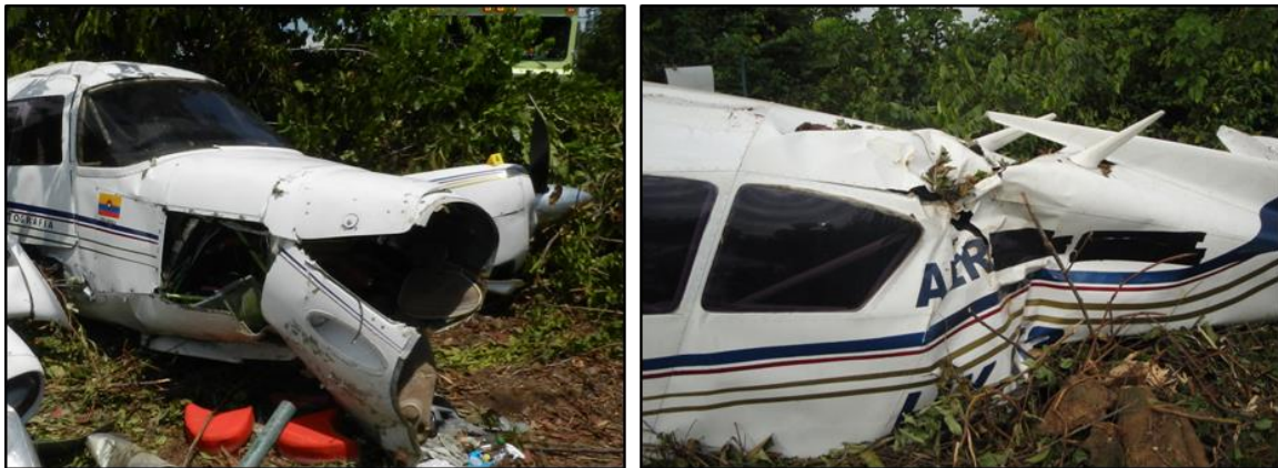
Daños estructurales en el fuselaje delantero y trasero
