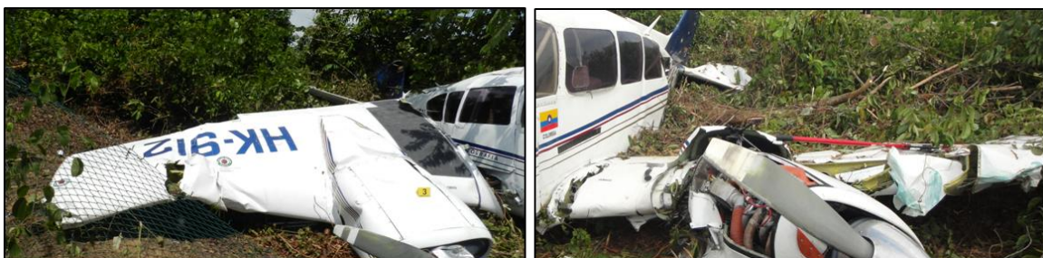
Desprendimiento y deformación de los planos izquierdo y derecho
